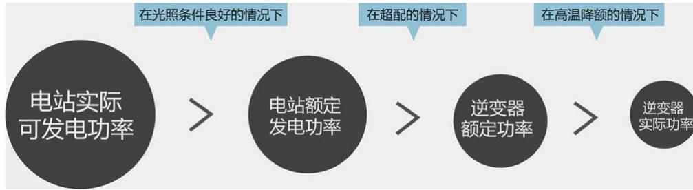
今年“领跑者 2.0”中重大改进项，就是将“领跑者 1.0”对组串式逆变器的低标准提升到与集中式标准相同高度，更加维护了“领跑者”的技术先进性，也是保证了投资人的利益。市场上有超载功能的逆变器种类繁多，但是高温下能使出洪荒之力，实现长期过载的就凤毛麟角了。其中全球光伏逆变器领军企业阳光电源设计的 SG50KTL，额定输出功率 48kW，采用智能风扇散热，保持在 45℃ 高温下长期 1.1 倍过载。
